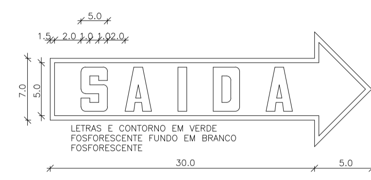
02 Detalhe Seta Indicadora de Saída sem
