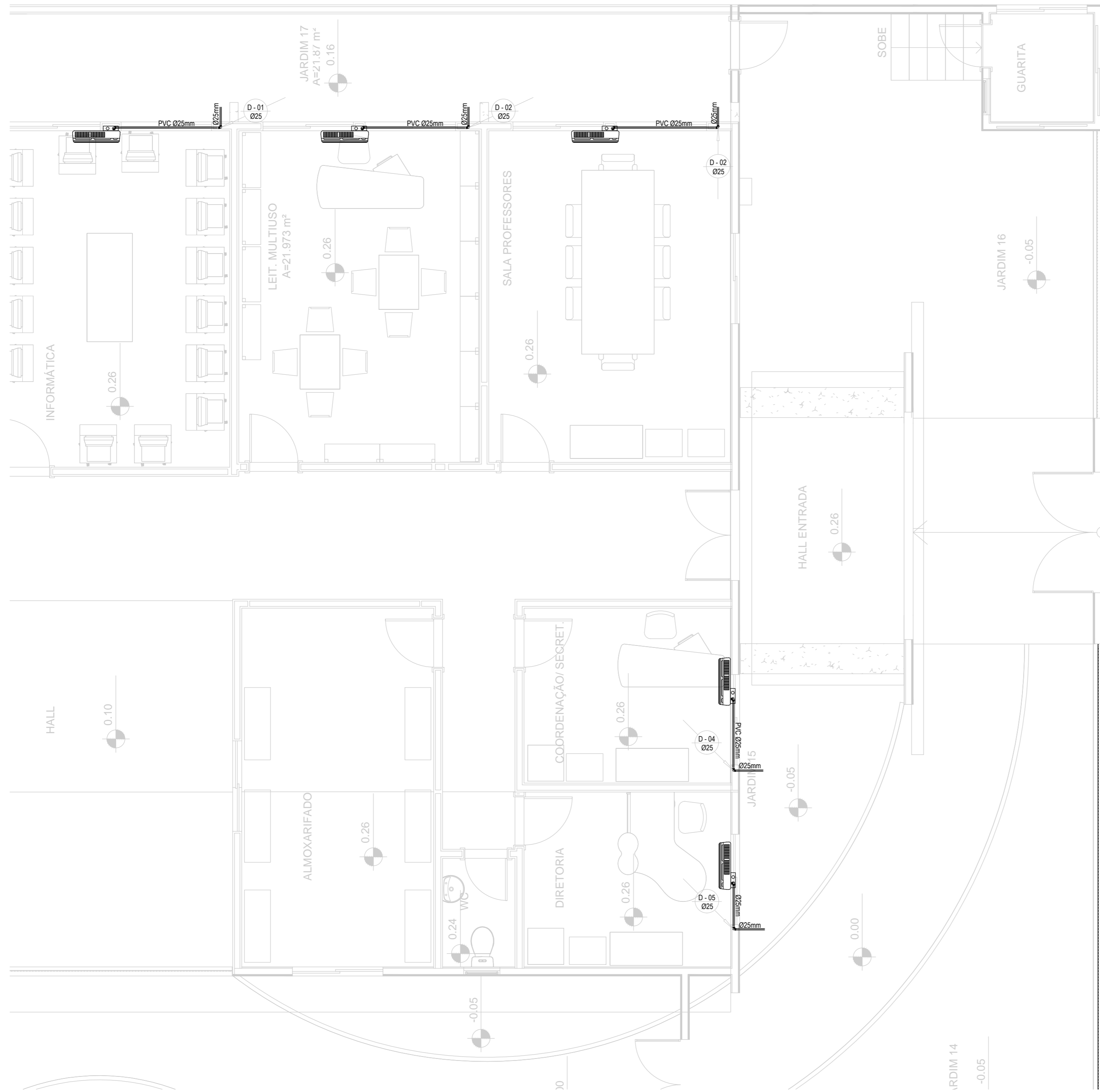
01 PLANTA BAIXA - DRENOS DOS AR-CONDICIONADO ESCALA : 1/50
