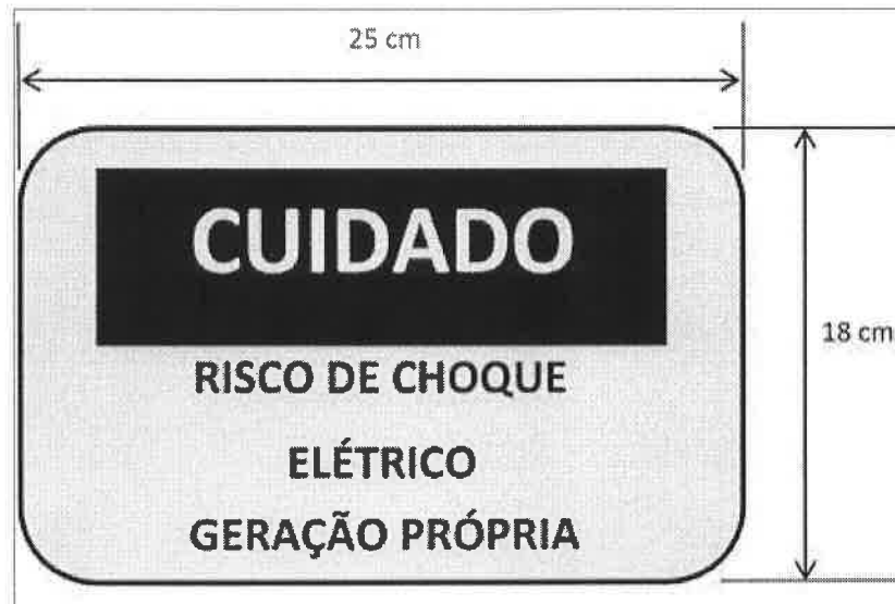
Figura 3: Placa de advertência.
