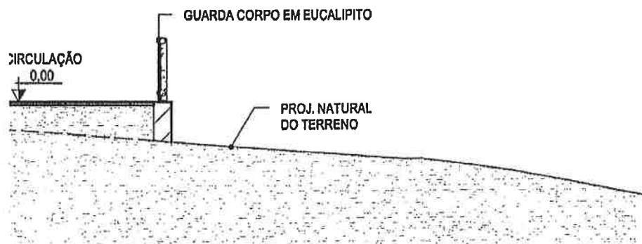
Figura: Corte do muro de arrimo e guarda corpo.
