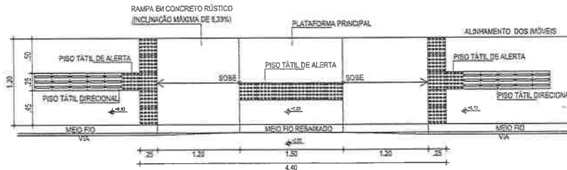
DETALHE - RAMPA TIPO 01 ESCALA: 1/50
